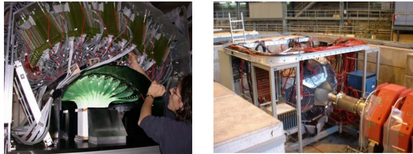
Abbildung 6: Zwei Detektoren zur Präzessionsmessung der Myonenlebensdauer: FAST (links) und \mu LAN (rechts) am Paul Scherrer Institut in Villingen / Schweiz
