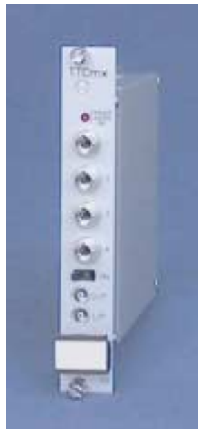
Fig. 2 TTCmx laser transmitter module
